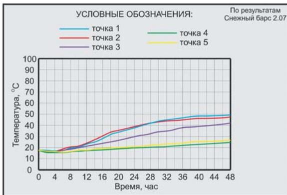
Рисунок 5. График изменения температуры бетона в контрольных точках
