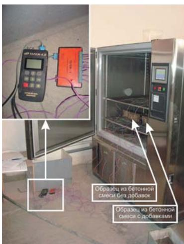
Рисунок 2. Расположение бетонных образцов в климатической камере
