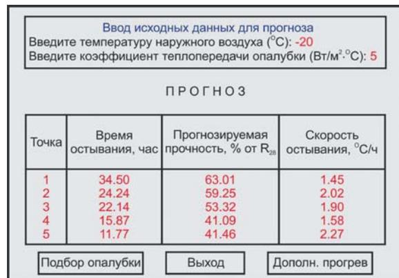
Рисунок 7. Результаты прогноза конечной прочности бетона при температуре наружного воздуха -20° С
