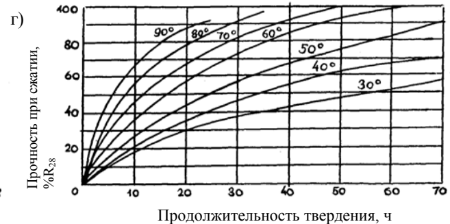
Рис. 1.7. Кривые набора прочности бетона при различных температурах его выдерживания: а, в – бетон М200 на портландцементе активностью 400...500; б, г – бетон М200 на шлакопортландцементе активностью 300...400
