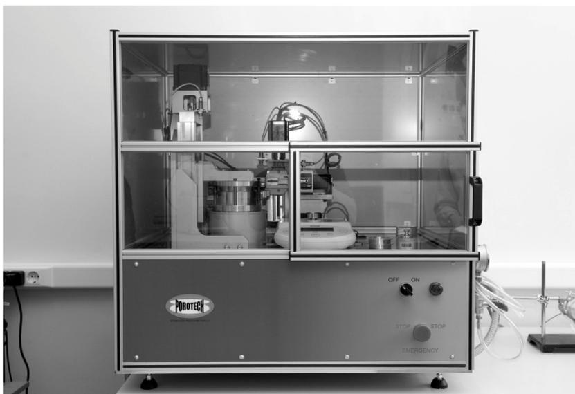
Рис. 1. Эталонный поромер Porotech 3.1
