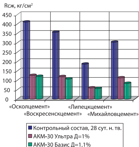
Рис. 5. Результаты испытаний добавок АКМ-30 по методу «холодного» бетона на различных цементах
