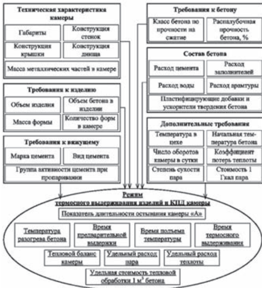
Рис. 4. Схема проектирования энергосберегающих режимов тепловой обработки бетона
