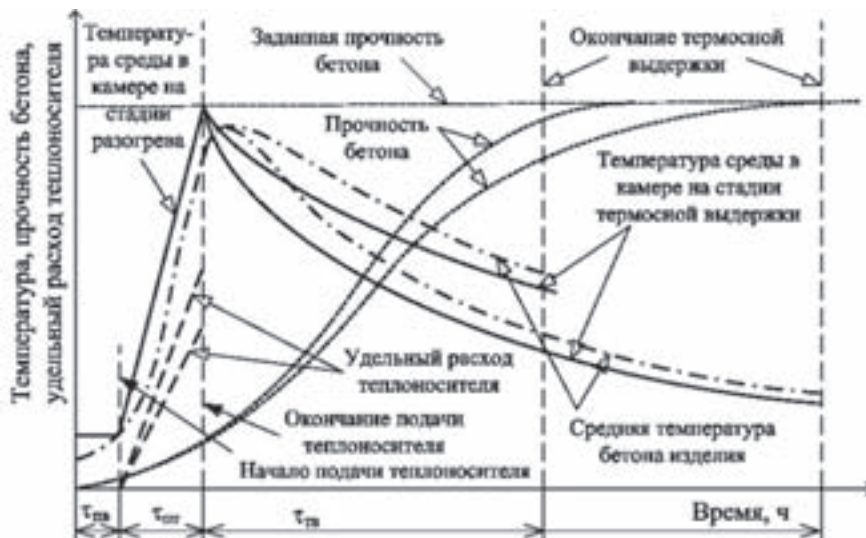
Рис. 2. Энергосберегающий режим тепловлажностной обработки бетона
