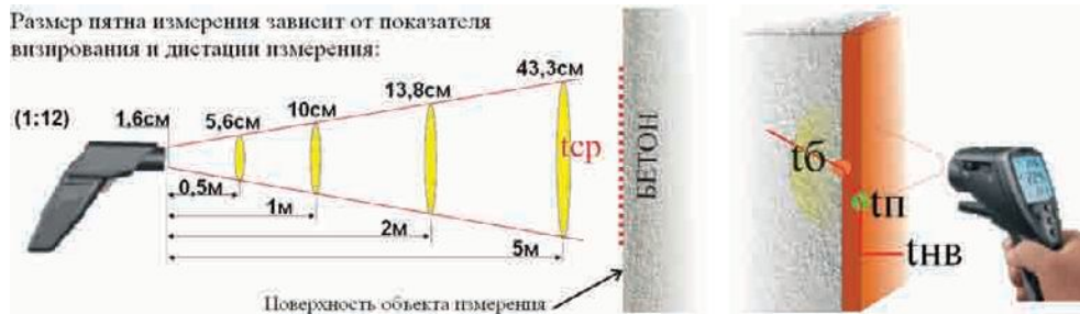
Рис.2. Общая принципиальная схема выполнения пирометрических измерений и схема косвенного измерения температуры бетона с использованием пирометра.
