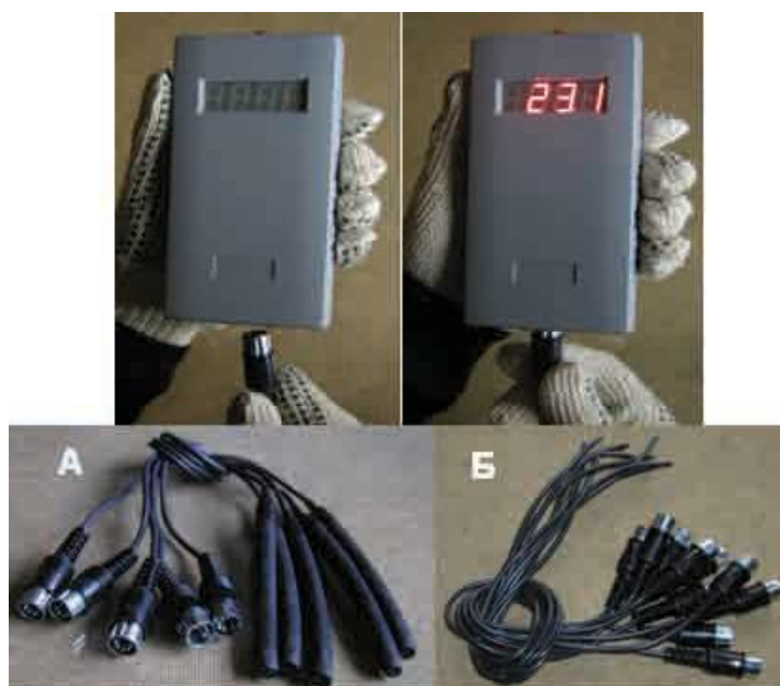
Рис.1. Приборный комплект для множественных измерений температуры бетона: а) – датчики комплекта в прочном упругом резиновом кожухе для установки непосредственно в бетон (прямые измерения температуры); б) – датчики в мягкой защитной оболочке для установки на опалубку (косвенные измерения температуры бетона)
